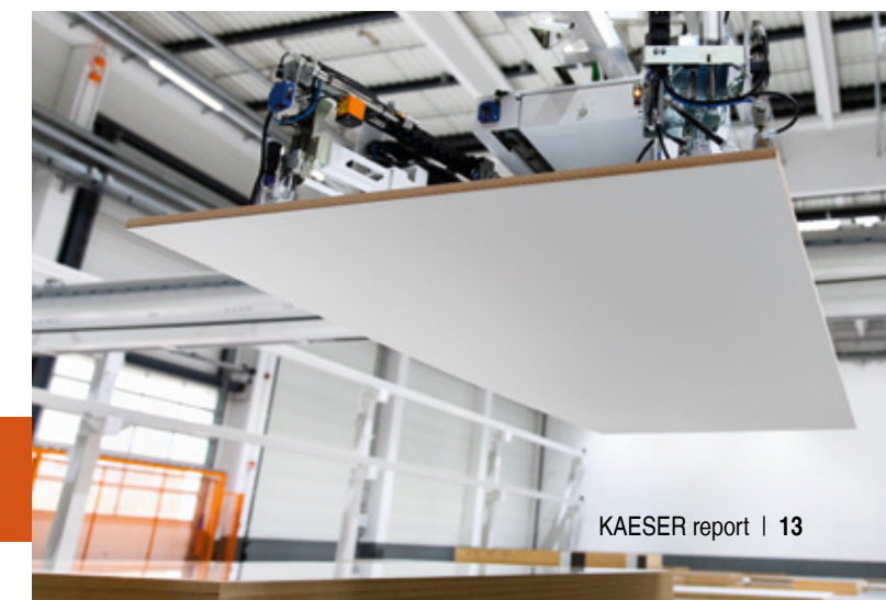
Les préhenseurs par le vide qui soulèvent les grands éléments ont besoin d'air comprimé (principe venturi).
