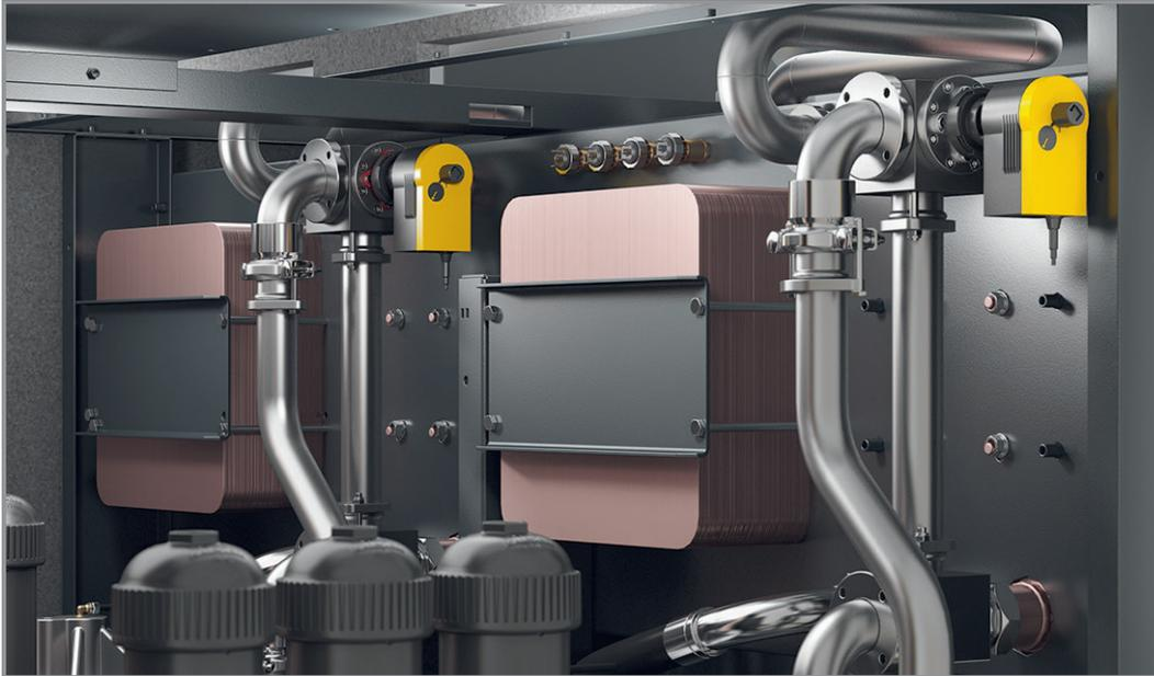
Le système intégré comprenant l'échangeur de chaleur, la soupape thermostatique et la tuyauterie complète ne nécessite pas d'espace supplémentaire autour du compresseur et peut récupérer jusqu'à 72 % de la consommation électrique totale des compresseurs HSD en utilisant la chaleur de l'huile.
